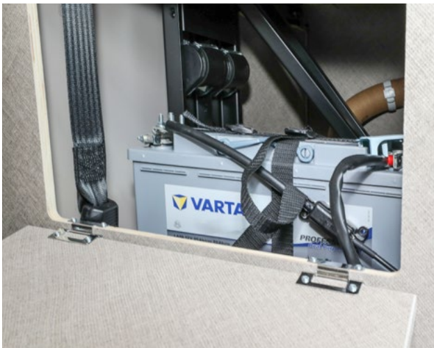
Ein Lithium-Akku wiegt nur etwa halb so viel wie eine Blei-Batterie (Foto). Der kostspielige Wechsel zahlt sich langfristig aus.
