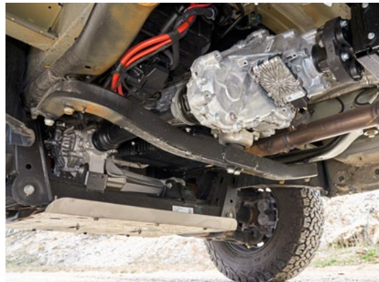
Beim Allrad kommt durch Zusatzkomponenten wie Differenziale und Antriebswellen viel Mehrgewicht ins Mobil.
